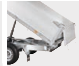
2 Wände 50 cm, mit Pendelbordwand hinten
