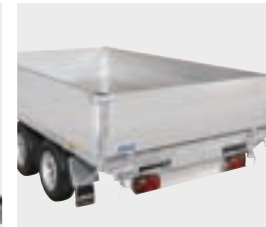
2 Wände 50 cm, Pendelbordwand hinten
