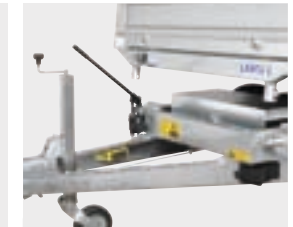
3 Elektrische Bedienung mit Handbedienungssatz
