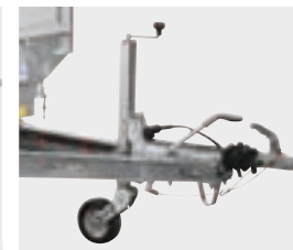
8 Automatikstützrad (Standard bei allen Kippern)
