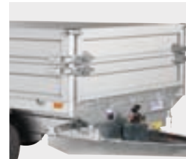
1 Wandaufsatz (oben scharnierend)
