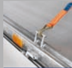
Anbindepunkt in V-Profil (Standard) DIN 400 daN (kg)
