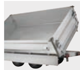
1 Wandaufsatz (oben scharnierend)
