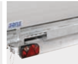
5 Aufnahmeschacht für Aufharschienen (Standard bei PKL)
