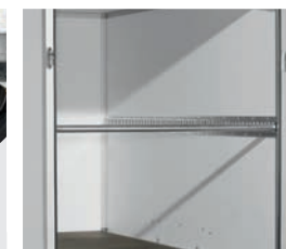
9 Rails met ladingstang (t.b.v. houten opbouw) (optie)
