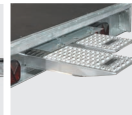
3 Geïntegreerde oprijplaten (optie)
