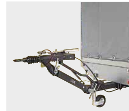
1 Höhenverstellbare Deichsel & Din-Zugöse (Option)
