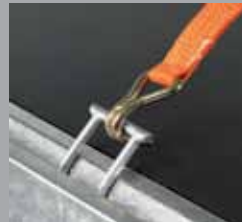
Anbindepunkt in V-Profil (PA) (Standard) DIN 400 daN (kg)
